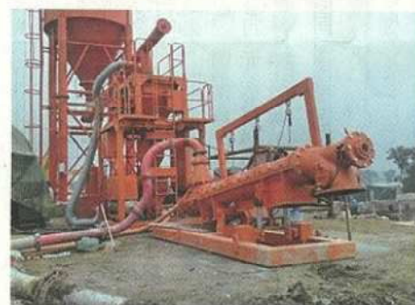
河川掘削泥土再利用システムの管路ミキサ
